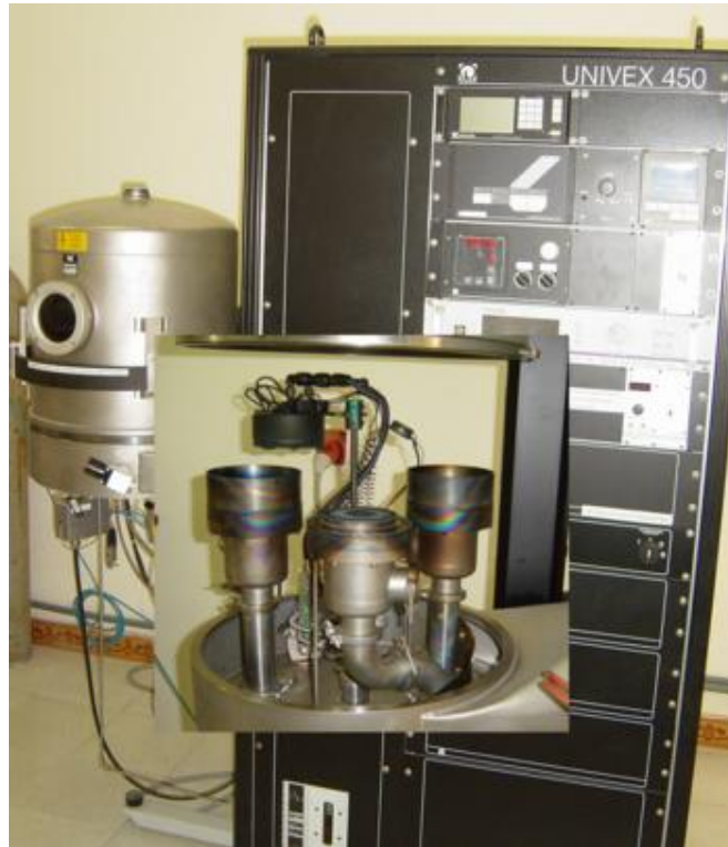
Hình 5: Hình ảnh thí nghiệm sputtering Univex 450 tại Trung tâm Nghiên cứu Khoa học Tự nhiên, Viện Công nghệ Hà Nội
